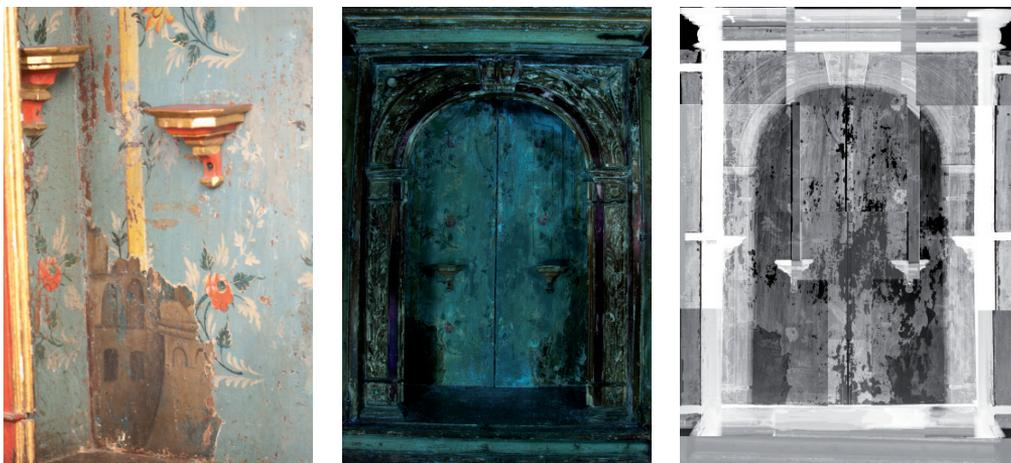
Imagem com fotografia visível das camadas primária e secundária e imagens internas com luz UV e raios X.
